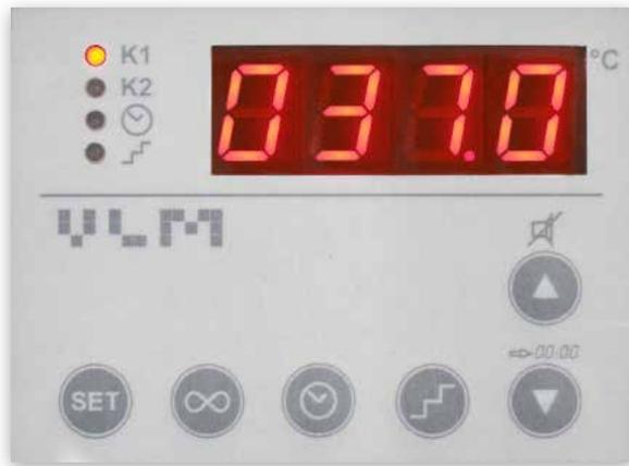
Die Funktion des Mikroprozessor-Reglers (PID)
