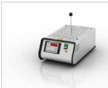
LS-Thermostate sind keine "Billig-Heizer", sondern stellen die preisgünstige Alternative zu den BIO-Thermostaten dar. Um knappen Budgets entgegenzukommen, wurde auf die mechanisch sehr aufwändige, massive Aluminiumheizwanne zugunsten einer montierten Wanne verzichtet. Deren Boden ist ebenfalls präzisionsgefräst, so dass ein guter Wärmeübergang in die Heizblöcke gewährleistet ist.
