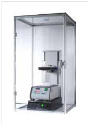
VLM-Evaporatoren sind eine preisgünstige Alternative zu Rotationsverdampfern und anderen Konzentratoren, wenn eine größere Anzahl Proben bearbeitet werden muss. Die Verdunstung des Lösungsmittels wird durch die Begasung mit Stickstoff beschleunigt, eine besonders für oxidationsempfindliche Proben schonende Methode. Die Metallblock-Thermostate dienen dazu, die Verdunstungskälte zu kompensieren, wodurch die Temperatur des Systems gehalten wird.
