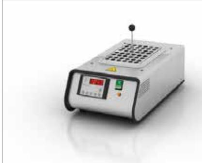
„High Performance“ Thermostate sind mit einer flüssigkeitsdichten massiven Aluminiumheizwanne für den Einsatz austauschbarer Heizblöcke (Bohrtiefe 65 mm) ausgestattet. Um höchste Ansprüche an die Genauigkeit zu erfüllen, können sie jedoch auch mit fest eingebauten Heizblöcken gefertigt werden – nicht nur mit Bohrungen für Standard Reagenzgläser, sondern auch für viele andere im Labor gebräuchliche Gefäße.
