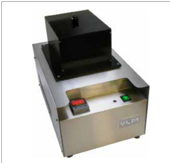
HC-Hochleistungs-Thermostate für 24 bzw. 48 Standardproben (16 mm Reagenzgläser) sind mit modernster Peltiertechnik ausgestattet. Eine spezielle Elektronik schützt die Peltierelemente vor den hohen Belastungen, die bei ständigem Wechsel zwischen Heizen und Kühlen auftreten, z.B. beim Temperieren bei Raumtemperatur.
