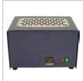
Hydroxyprolin Aufschluss-Thermostat, pulverbeschichtet
