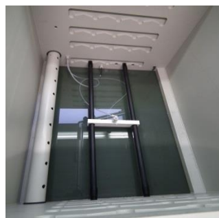
Luftverteiltröhr für gleichmäßige Trocknung der Proben
