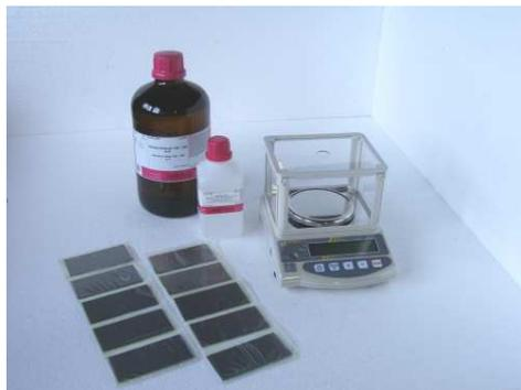
Um die Vergleichspräzision und Wiederholpräzision der mit einer einzelnen Kammer oder mit ähnlichen Geräten in unterschiedlichen Laboratorien erhaltenen Prüfergebnisse zu bewerten, ist es gemäß EN ISO 9227:2006 (D) erforderlich, die Korrosivität des Korrosionsprüfgerätes regelmäßig zu überprüfen.
