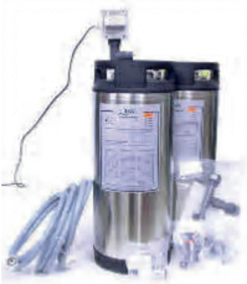
Zur Überwindung des im Befeuchter herrschenden Luftdrucks wird ein Wasseranschlussdruck von 2 - 4 bar benötigt. Der möglichst in der Nähe des Gerätes installierte Wasserhahn muß ein 3/4" Außengewinde für den Anschluß des Druckschlauches zur Ionenaustauscherpatrone besitzen.
