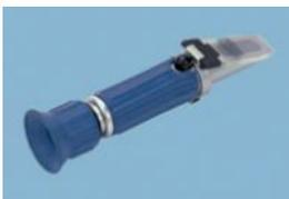
Zur Prüfung der NaCl-Konzentration:
