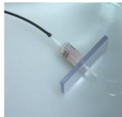
Servicefreundlich: Der einfache Wechsel des Testlösungsfilters. Bei einer zentralen Testlösungsversorgung bieten wir einen Direktanschluss in Verbindung mit einem 16 L internen Zwischentank als Option an, so dass auf einen großen Tank verzichtet werden kann. Die Testlösung kann direkt im Vorratstank bereitet werden. Das SaliCORR® Natriumchlorid lässt sich größtenteils mit den Wasserstrahl lösen. Als Zubehör bieten wir jedoch auch eine Umwälzpumpe mit Tankaufsatz an.
